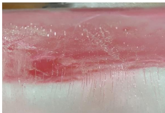
Рисунок 3. Растекание нефти по поверхности мёрзлой среды (вид сбоку)
