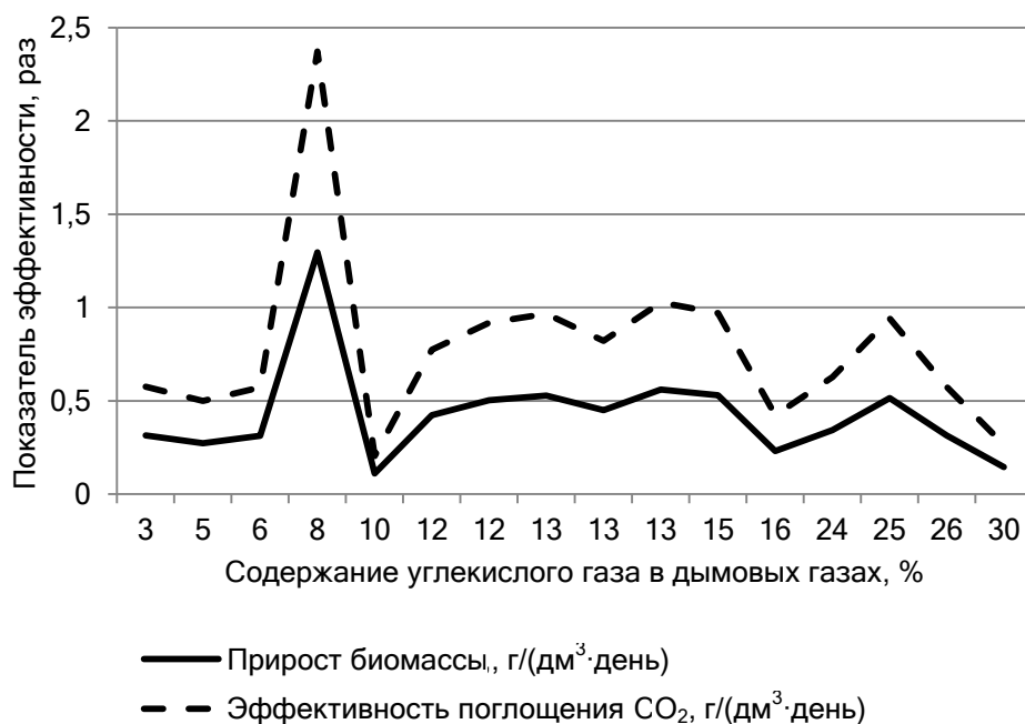
Рисунок 2. Эффективность поглощения CO 2 от его содержания в дымовых газах
