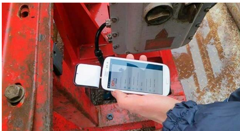
Рисунок 2. Пример портативного считывателя RFID, работающего совместно со смартфоном
