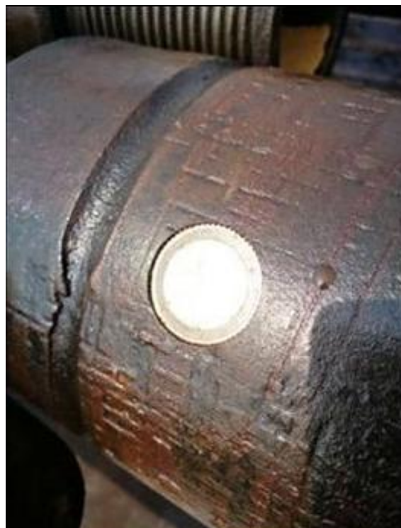
Рисунок 3. RFID-метка, закрепленная на буровой трубе
