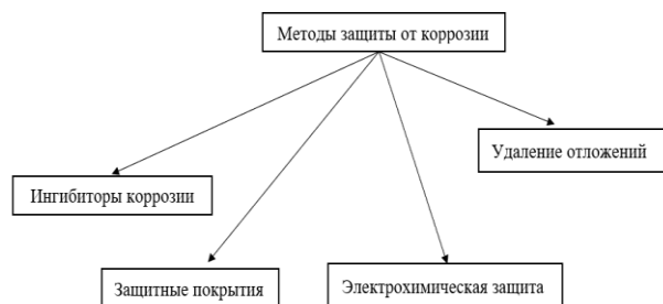
Рисунок 4. Способы защиты промышленных трубопроводов от коррозии
