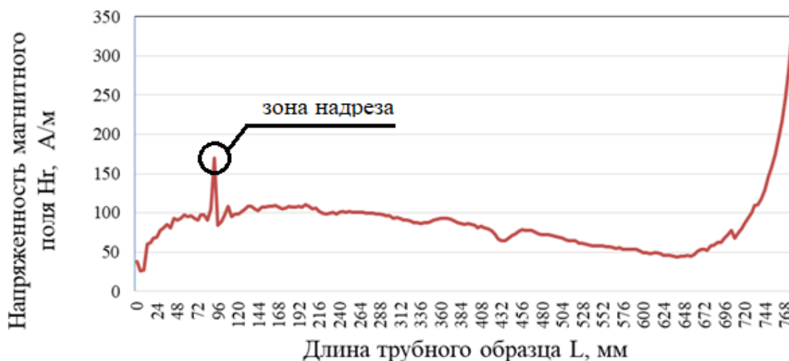
Рисунок 3. Зависимость результирующей напряженности магнитного поля от длины рабочей зоны трубного образца при изгибающих деформациях
